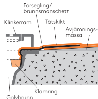
Figur 8. Anslutning av tätskikt mot golvbrunn med klämring.
